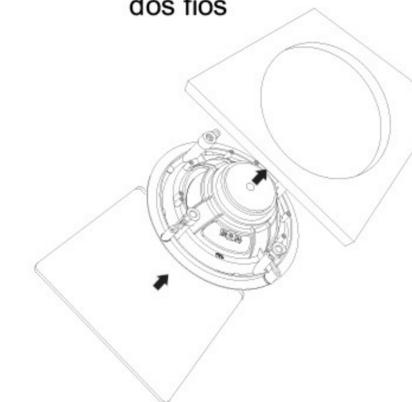
**04** Passo 4. Encaixe a arandela ao recorte do teto, para travá-la basta apertar os parafusos de fixação, conforme figura e as travas se prenderão automaticamente.
